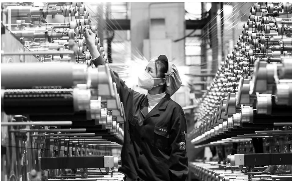
在技术创新的推动下,曾是加工代名词的中国纺织业踏上“智造”之路。2016至2019年,纺织行业共有11项成果获国家科学技术奖。图为在山东省威海市某碳纤维生产车间,工人正在检查电子计米器上显示的产品长度。新华社记者 陈建力摄
